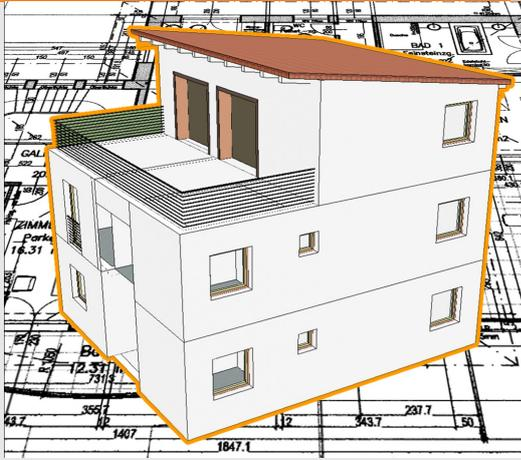
Raumtool 3D ist eine Software zum schnellen, einfachen und sicheren grafischen Erfassen von Gebäudedaten im europäischen Bemaßungs-Standard für die Weiterverarbeitung in SOLAR-COMPUTER-Berechnungs-Programmen. Das Erfassen erfolgt in Projekt-Layern mit Durchsicht auf einen Hintergrund-Layer, der den Grundriss einer aus CAD oder anderweitig erzeugten DXF-, DWG-, pdf- oder Bild-Datei darstellt.
